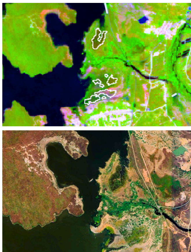
Figura 15 – Validação de área alagada identificada como espelho d'água no município de Itaúba, com base em imagens Sentinel-2 (parte superior) e Google Earth Pro (parte inferior), ambas referentes ao ano de 2024.
