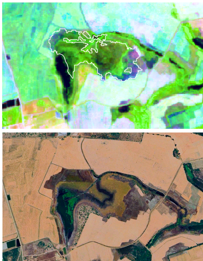
Figura 14 – Validação de área alagada identificada como espelho d'água no município de Jaraguana, com base em imagens Sentinel-2 (parte superior) e Google Earth Pro (parte inferior), ambas referentes ao ano de 2024.
